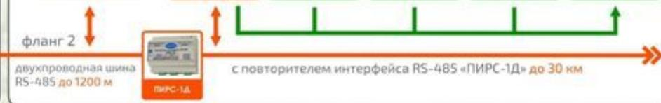
возможно объединение в сеть до 4-х концентраторов «Мурена-Орион», тогда количество периметровых устройств в комплексе может быть до 1000
