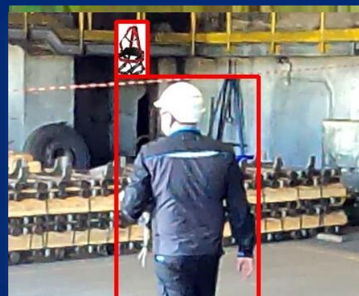
Отсутствие страховоу привязи
