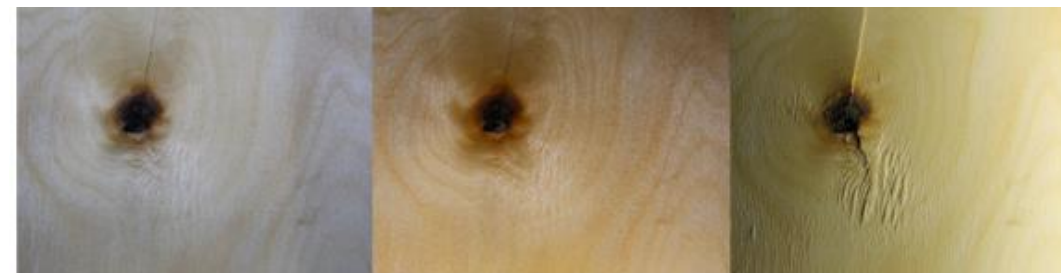
Фотография 1. Пример дефекта «Сучок» при разном освещении.
