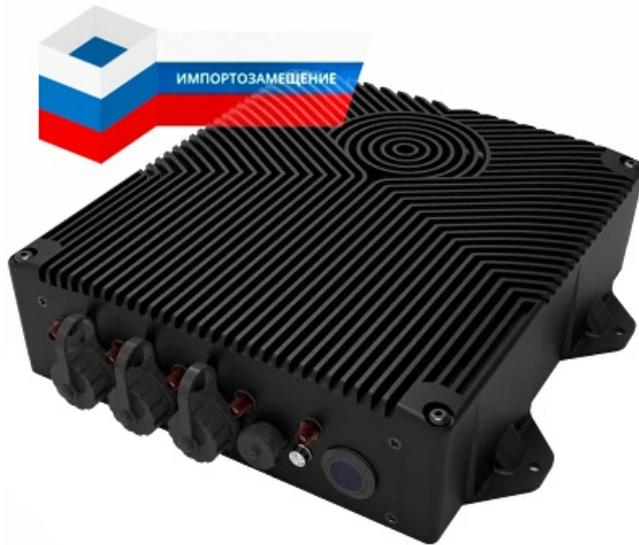
Отечественный вычислитель на 32 HD-канала с защитой IP65
