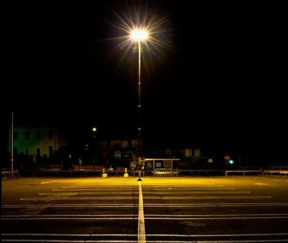
Для равномерного освещения большой площади парковки подойдет оптика типа «T4» или «VSM»
