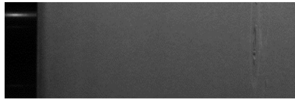
Плена по неметаллическому включению
