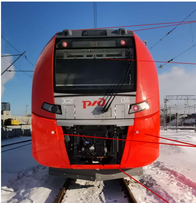
ИК камеры с системой очистки
