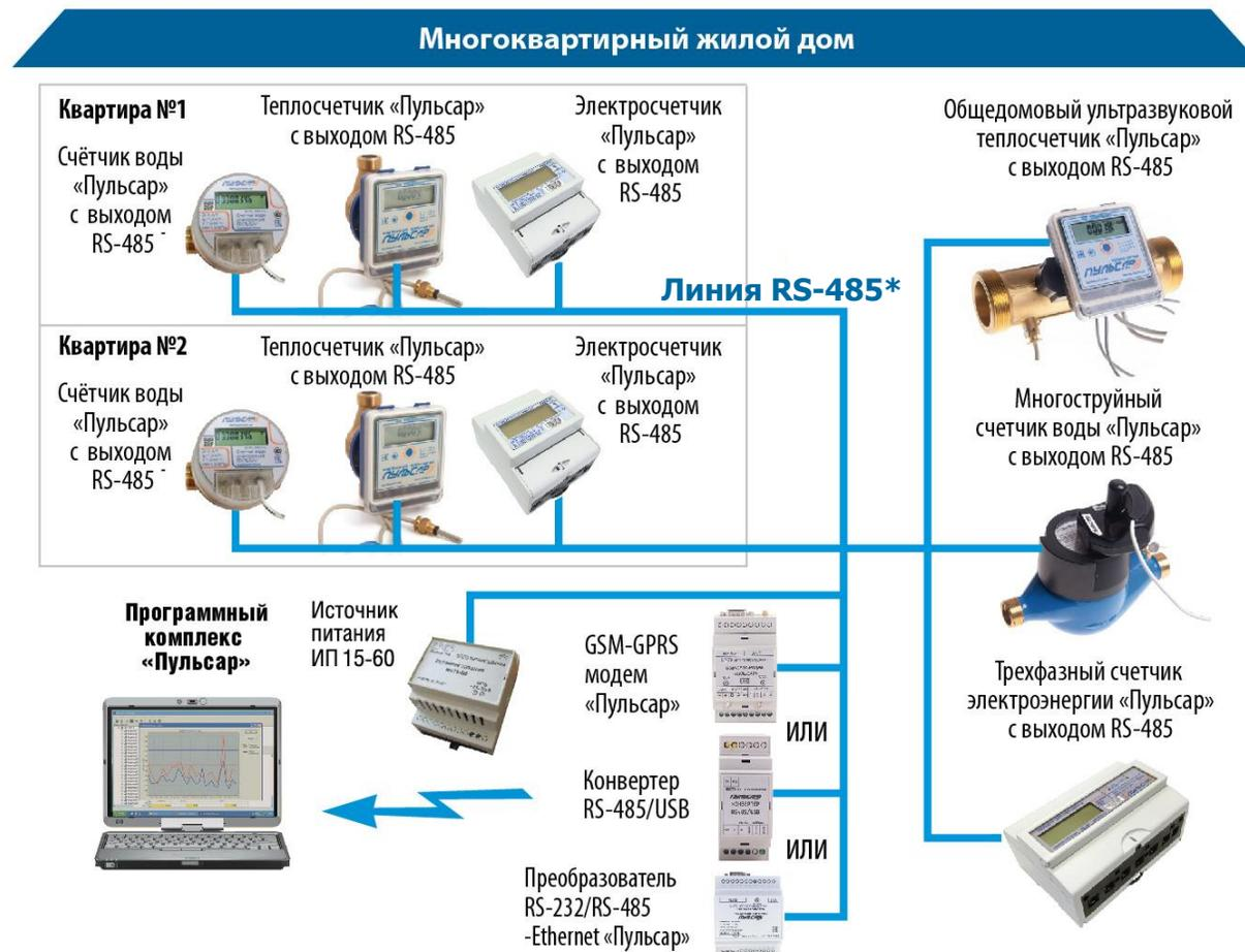
\*Каждый тип приборов подключается на отдельную шину
