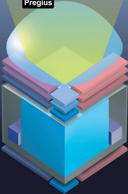
Фотодиод расположен ближе к микролинзе. Это обеспечивает лучшие условия для падения света на его поверхность
