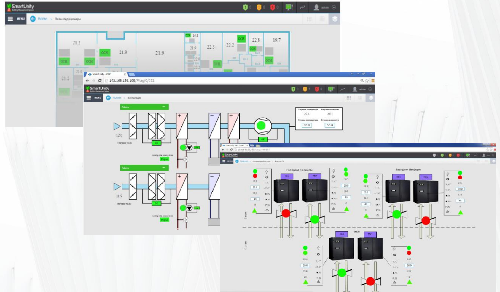
Интерфейсы SCADA/BMS системы
