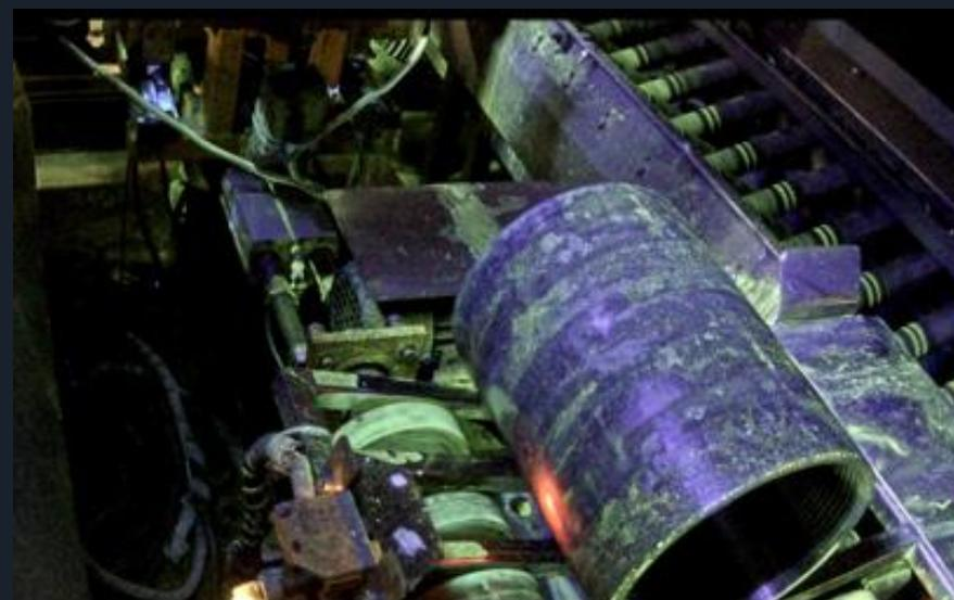
Автоматизированный контроль за утечками на установке гидроиспытаний труб
